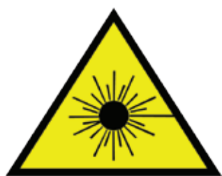
ADVERTÊNCIA–Radiação laser visível e invisível.
