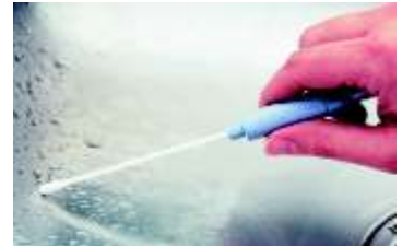
MVP ATP tyčinka pro odběr vzorku je aktivována v jediném kroku
